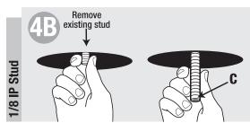
1/8 IP stud: Replace existing stud with nipple (C).
